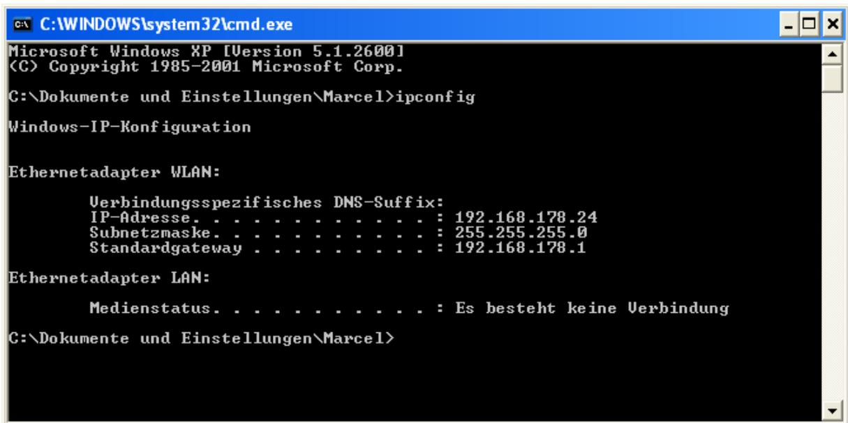
(Abb 2: Konsolenfenster mit ausgeführtem Konsolenbefehl „ipconfig“)
